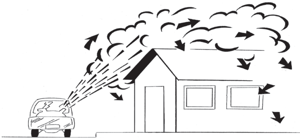
Figura 20. Dispersão da neblina em aplicações espaciais a Ultra Baixo Volume
